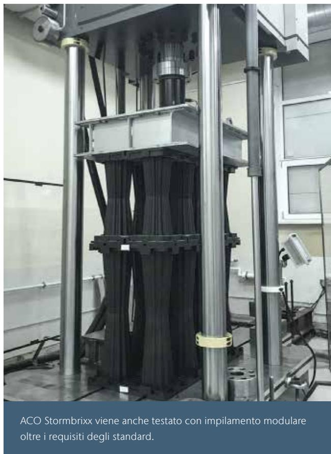
ACO Stormbrixx viene anche testato con impilamento modulare oltre i requisiti degli standard.
