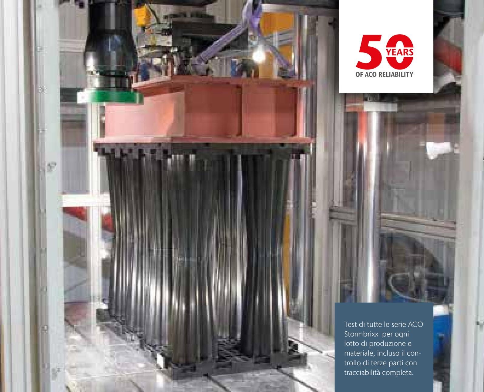
Test di tutte le serie ACO Stormbrixx per ogni lotto di produzione e materiale, incluso il controllo di terze parti con tracciabilità completa.
