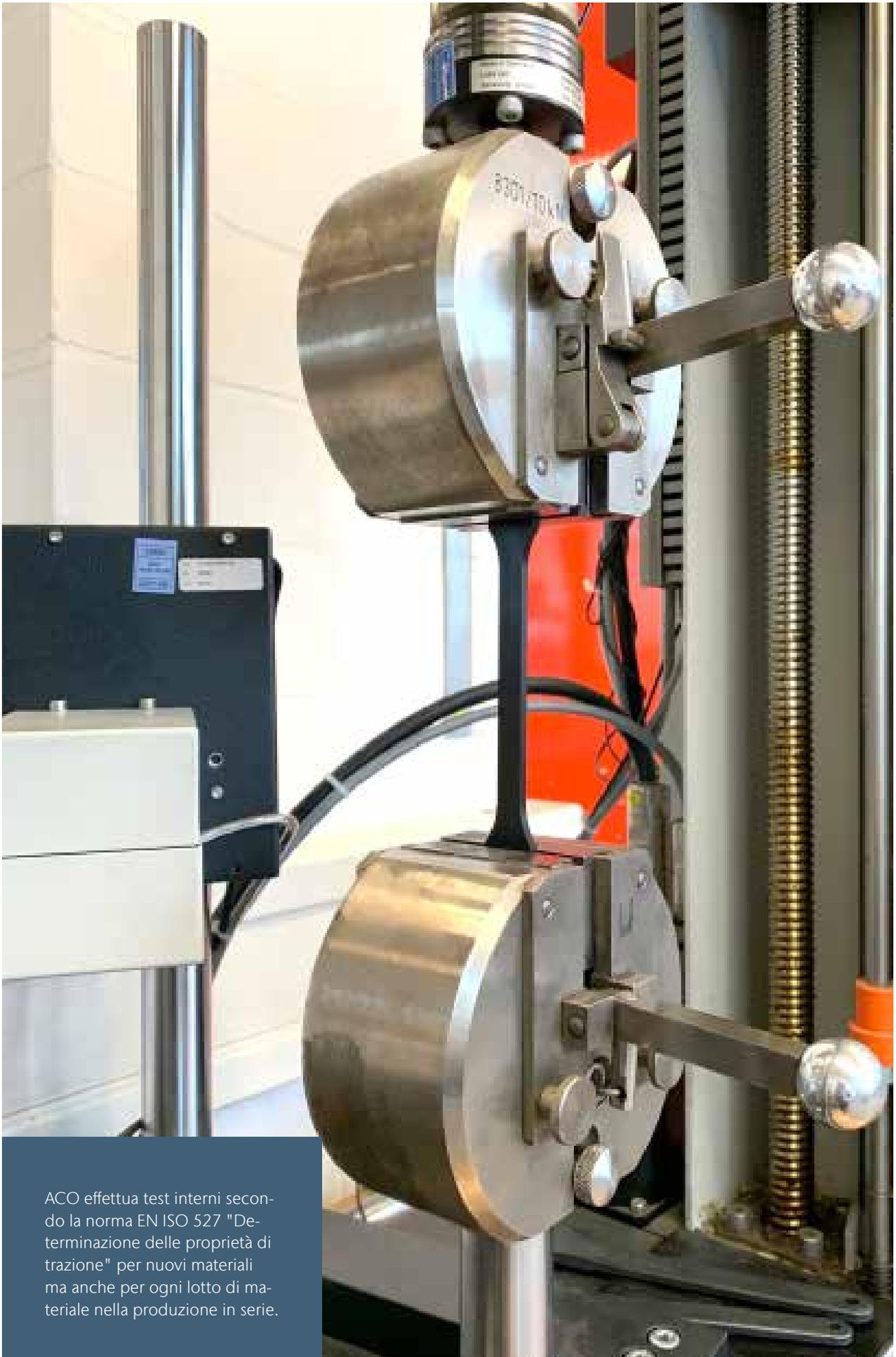
ACO effettua test interni secondo la norma EN ISO 527 "Determinazione delle proprietà di trazione" per nuovi materiali ma anche per ogni lotto di materiale nella produzione in serie.
