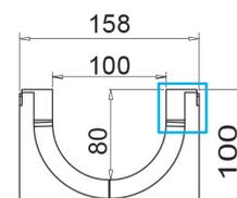
Tenuta all'acqua: per assicurare la tenuta stagna delle canalette, si consiglia l'utilizzo di un adesivo sigillante bituminoso. A garanzia completa e duratura dell'assenza di perdite attraverso i giunti delle canalette, si può provvedere alla saldatura a caldo dei giunti stessi.
