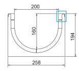
Tenuta all'acqua: per assicurare la tenuta stagna delle canalette, si consiglia l'utilizzo di un adesivo sigillante bituminoso. A garanzia completa e duratura dell'assenza di perdite attraverso i giunti delle canalette, si può provvedere alla saldatura a caldo dei giunti stessi.
