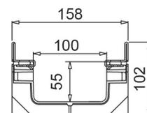
Tenuta all'acqua: per assicurare la tenuta stagna delle canalette, si consiglia l'utilizzo di un adesivo sigillante bituminoso. A garanzia completa e duratura dell'assenza di perdite attraverso i giunti delle canalette, si può provvedere alla saldatura a caldo dei giunti stessi.
