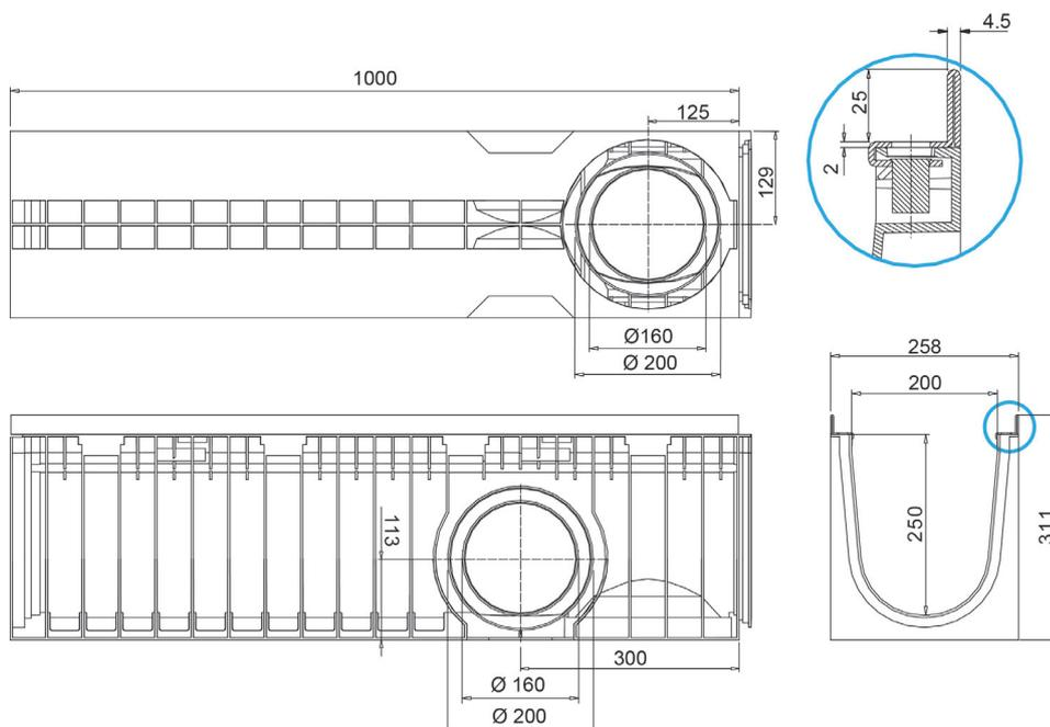
Tenuta all'acqua: per assicurare la tenuta stagna delle canalette, si consiglia l'utilizzo di un adesivo sigillante bituminoso. A garanzia completa e duratura dell'assenza di perdite attraverso i giunti delle canalette, si può provvedere alla saldatura a caldo dei giunti stessi.
