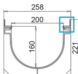
Tenuta all'acqua: per assicurare la tenuta stagna delle canalette, si consiglia l'utilizzo di un adesivo sigillante bituminoso. A garanzia completa e duratura dell'assenza di perdite attraverso i giunti delle canalette, si può provvedere alla saldatura a caldo dei giunti stessi.
