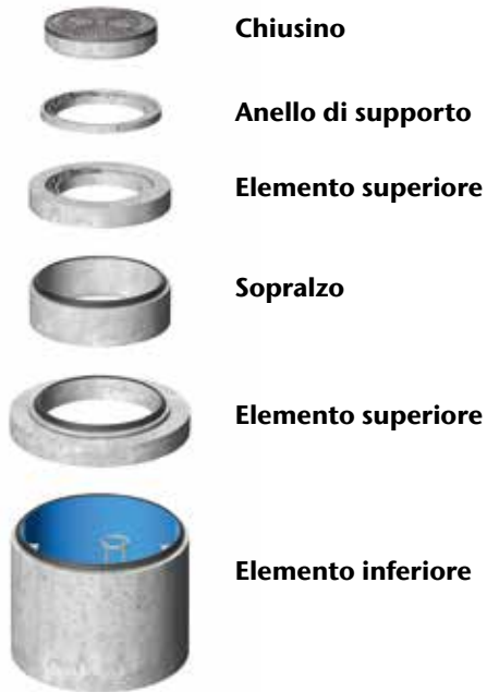
Esempio di separatore con elementi superiori ed anelli di sopralzo
