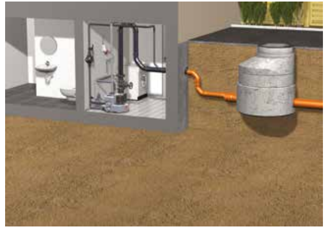
Protezione antiriflusso mediante impianto di sollevamento posto al di sotto del livello della fognatura.
